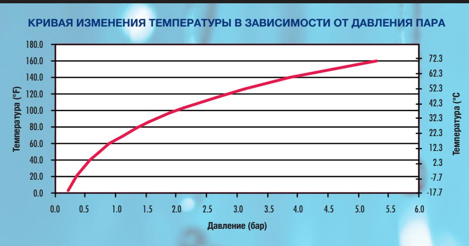
РИСУНОК 2 ТЕМПЕРАТУРА (°F/°C) В СРАВНЕНИИ С ПЛОТНОСТЬЮ ВСПЕНИВАЮЩЕГО ВЕЩЕСТВА FORANE® FBA 1233ZD
