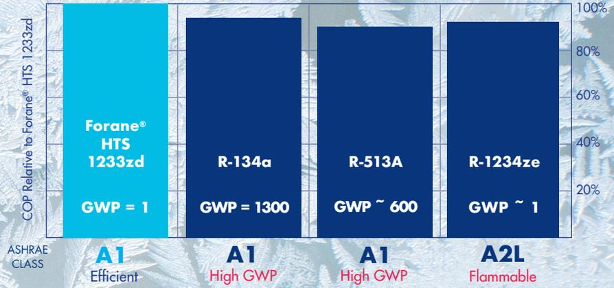
توفر مادة التبريد فوران® إتش تي إس 1233 زد تي توازناً مثالياً لخصائص مادة التبريد لاستخدامها في مبردات الطرد المركزي، إلى جانب الكفاءة العالية والأثر البيئي المنخفض وعدم قابلية الاشتعال.
